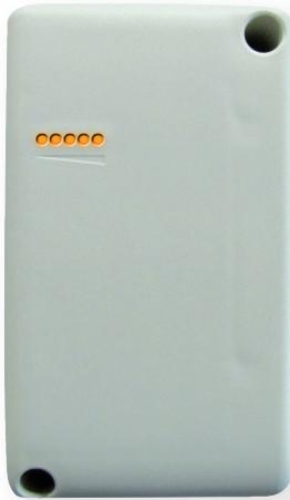
1 GPRS-Datenmodul mit integriertem Funkempfänger
